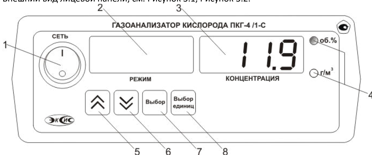
Рисунок 3.1 Вид лицевой панели газоанализатора, исполнение ПКГ-4 /1-С-К-2А
